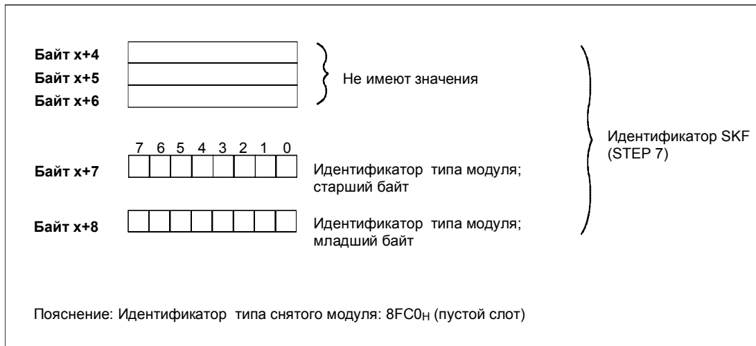
Рис. 6–21. Структура, начиная с байта x+4, для прерывания по установке или снятию модуля
